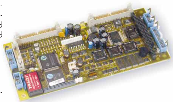
Baugruppe zur Regelung und Betriebsführung
